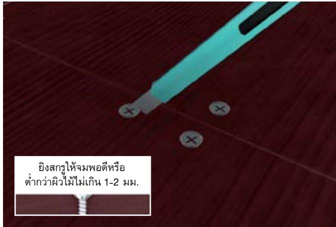
1. หลังจากยิงสกรูยึดไม้พื้นเมื่อว่า เข้ากับโครงสร้างไม้แล้วโครงสร้าง คงเหลือ โดยยิงสกรูให้หัวสกรูมอมดีเสมอระดับผิวไม้ หรือจมต่ำกว่า ระดับผิวไม้ไม่เกิน 1-2 มม. เรียบร้อยแล้วให้เช้มีดบางๆหรือกระดาษทราย ขัดกัดแต่งไฟเบอร์เวฟของรอบรูสกรูให้เรียบเสมือนระดับผิวไม้
